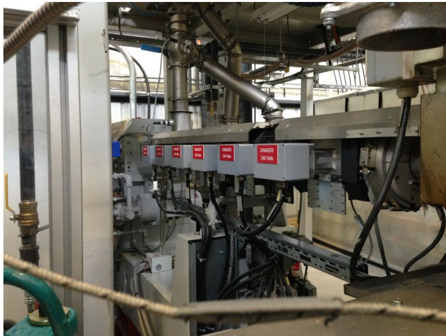
Figure 3-3 The first extruder (ZSE) of Dieffenbacher D-LFT-ILC line.
