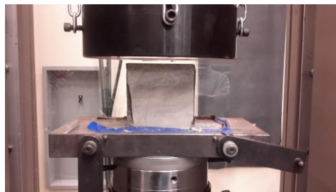
Figure 3: Montage pour les essais de compression sur les blocs de pierre calcaire.
